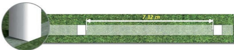
ゴールポストの形状が（上方から見て）長方形の場合、長い方の側面はゴールラインに対して直角でなければならない。クロスバーの長い方の側面は、フィールド面に対して平行でなければならない。
