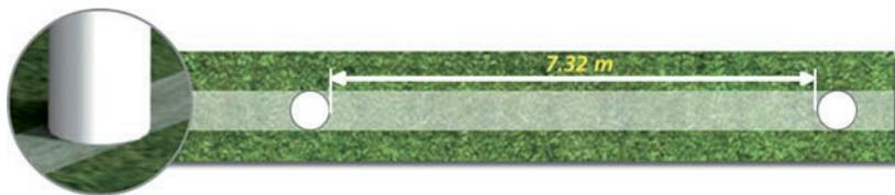
ゴールポストとクロスバーは、同じ幅と同じ厚さで、12cm（5インチ）以下とする。ゴールラインの幅はゴールポストおよびクロスバーの厚さと同じでなければならない。<sup>e)</sup> ネットをゴールとその後方のグラウンドに取り付けることができるが、それは適切に支えられ、ゴールキーパーの邪魔にならないようにする。
